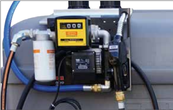
Pompe PLATINE, filtre à eau et particules en option
