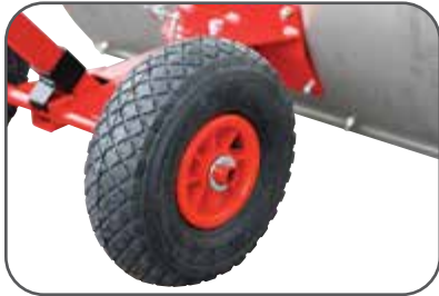
Roues gonflables, moyeu à roulement
