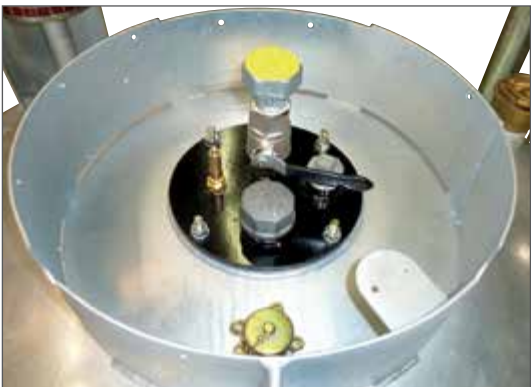
Vu du dessus, cuve sans pompe
