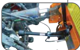
Accrochage, cardan et commande hydraulique d'ouverture de trappe trémie
