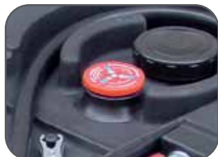
Soupape de surpression et d'aération
