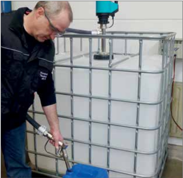
Pompe ATEX, pour solvants et liquides inflammables
