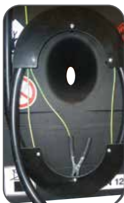
Paroi antirouils et système de rangement du flexible
