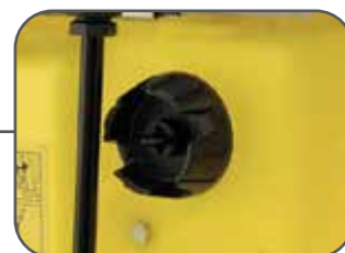
Bouchon de remplissage avec évent intégré
