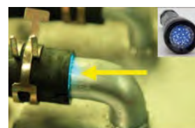
Produit de contraste identifiable grâce à la lumière UV et aux lunettes spéciales
